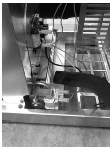
Fig. 39 - Limpieza ventilador ambiente
