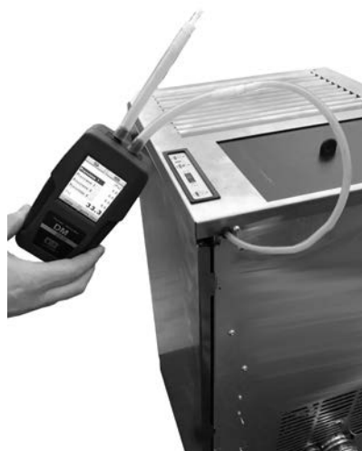
Fig. 31 - Conexión del presostato digital
